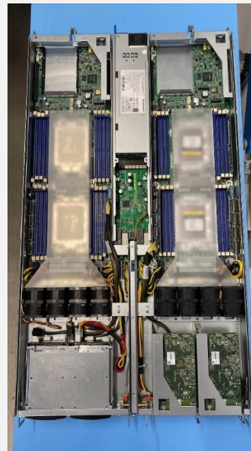
Шасси с установленными модулями Тип 1 и Тип2
