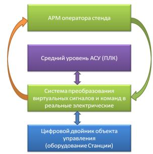
Схема полунатурного стенда моделирования работы станции (hardware-in-the-loop)
